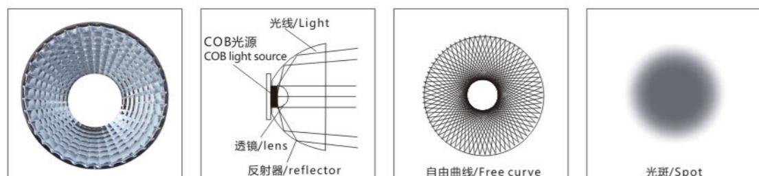
反射器的凸面镜表面经过精心设计，能产生微型反射光，在不降低光学性能的前提下改善光分布，从而提高灯具效率。可以选用可互换式反射器改变光束，包括在射灯已经安装的情况下。
