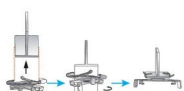
2 调整好易力夹套件方向，把轨道垂直转入易力夹套件内,最后左旋易力夹固定轨道（如图所示）
