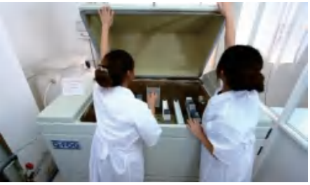
盐雾试验机 Q-FOG Salt Spraying Tester
