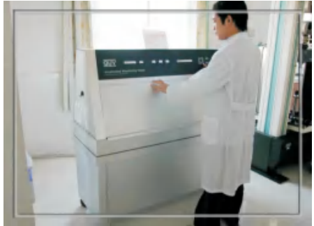
加速耐候试验机 QUV Accelerate Aging Tester
